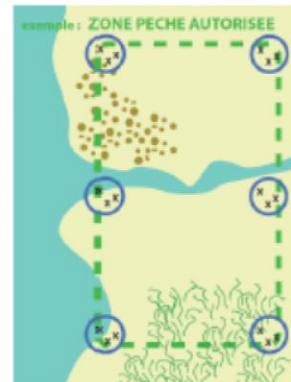
Fig.1 : stratégie d'échantillonnage : une zone de 100m X 50m est décrite par 6 stations positionnées selon un maillage de 50m. Trois réplicats sont réalisés au hasard dans chaque station.
