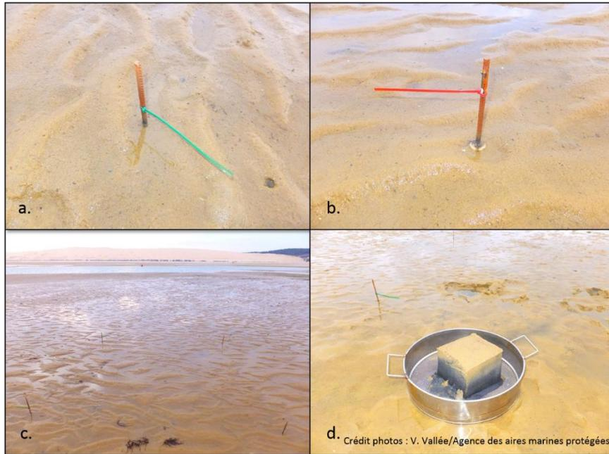
**Figure 106 - Dispositif expérimental (a. Tige de fer d'un quadrat témoin ; b. Tige de fer d'un quadrat gratté ; c. Quadrats de la zone d'étude ; d. Carotte de prélèvement disposé dans un tamis maillé sur 1 mm)**
