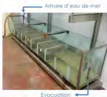
Figure 13 : Dispositif expérimental réalisé dans la salle thermorégulée (T=14°C) de la station marine de Wimereux
